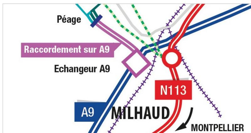
Un seul tracé est possible du fait des normes géométriques autoroutières (distance entre échangeurs, présence d'un ouvrage de franchissement de la voie ferrée, courbe de l'autoroute...).
